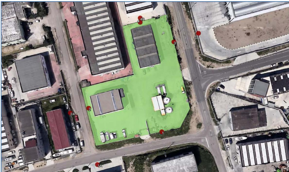
Figura 5 - Dislocazione dei punti di posizionamento del fonometro durante le misure effettuate alla GISCA
